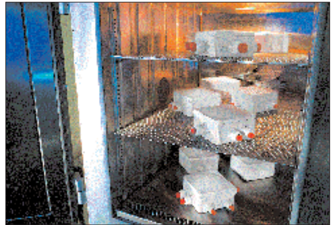
Climatical testing of junction boxes Abzweigkästen im Klimatest
